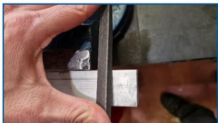
Bloccaggio del profilo a L in una morsa
