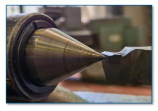
Bloccaggio della punta di centraggio nella testa di serraggio
