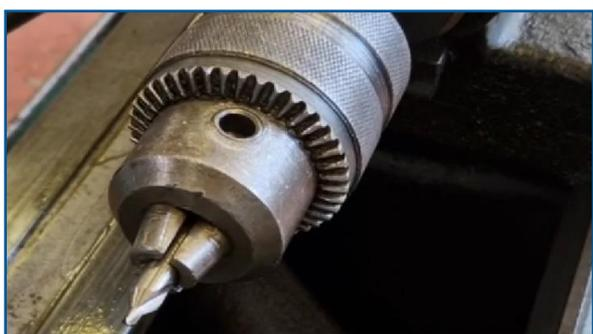
Bloccaggio della punta di centraggio
